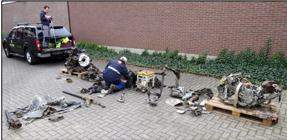
Figuur 70 Reconstructie van de brokstukken, april 2016. De vernietiging is mede te wijten aan de impactsnelheid van 840 km/u. (foto Cynrik De Decker)
