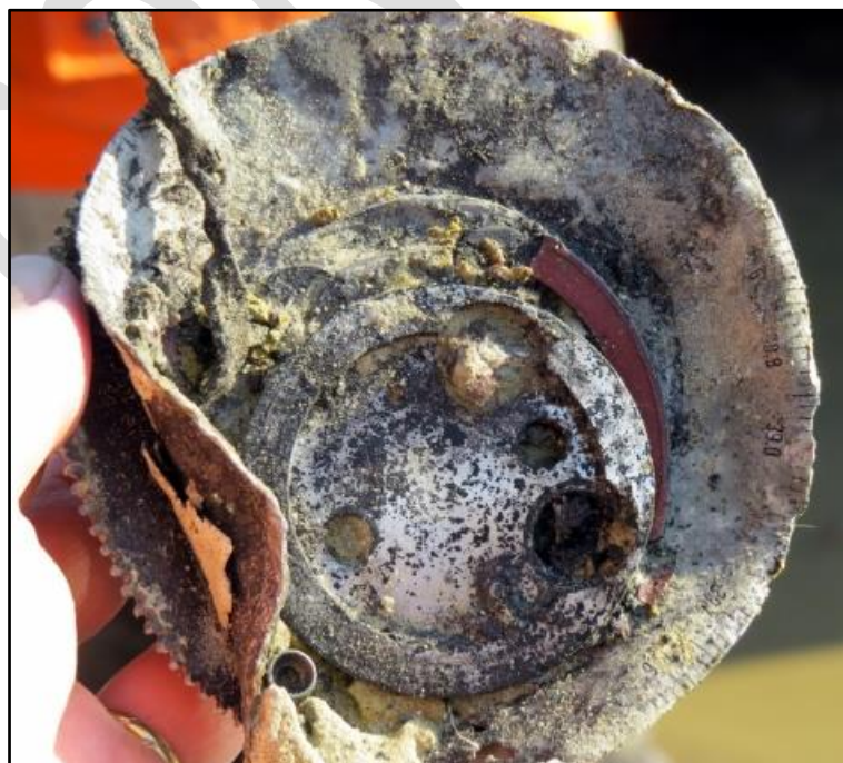
Figuur 31. Radio-afstemplaat FuG 16 (foto Cynrik De Decker)
