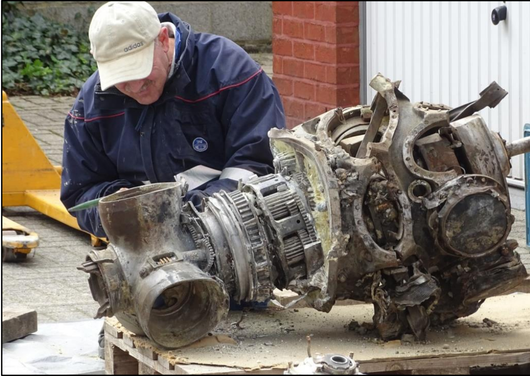
Figuur 23. Marc Bracke bij wat rest van de BMW 801-motor. Vooraan de schroefnaaf – tijdens de berging werd geen enkel propellorblad gevonden, wat doet vermoeden dat deze bij de aanraking met de bodem afbraken en weggeslingerd werden. Hieruit kan afgeleid worden dat de motor op het moment van de inslag nog op volle toeren draaide (Foto Cynrik De Decker)
