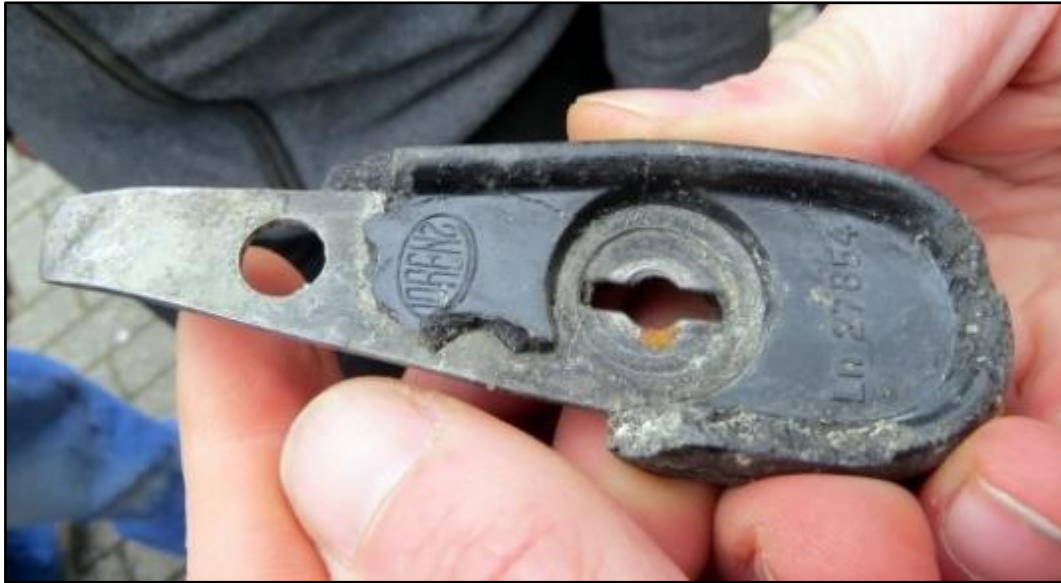
Figuur 32. De afstemsleutel van de FuG 16 (foto Cynrik De Decker)
