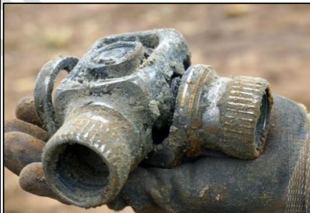
Figuur 28. Gewricht stuurknuppel onderaan (foto Floris Beke)
