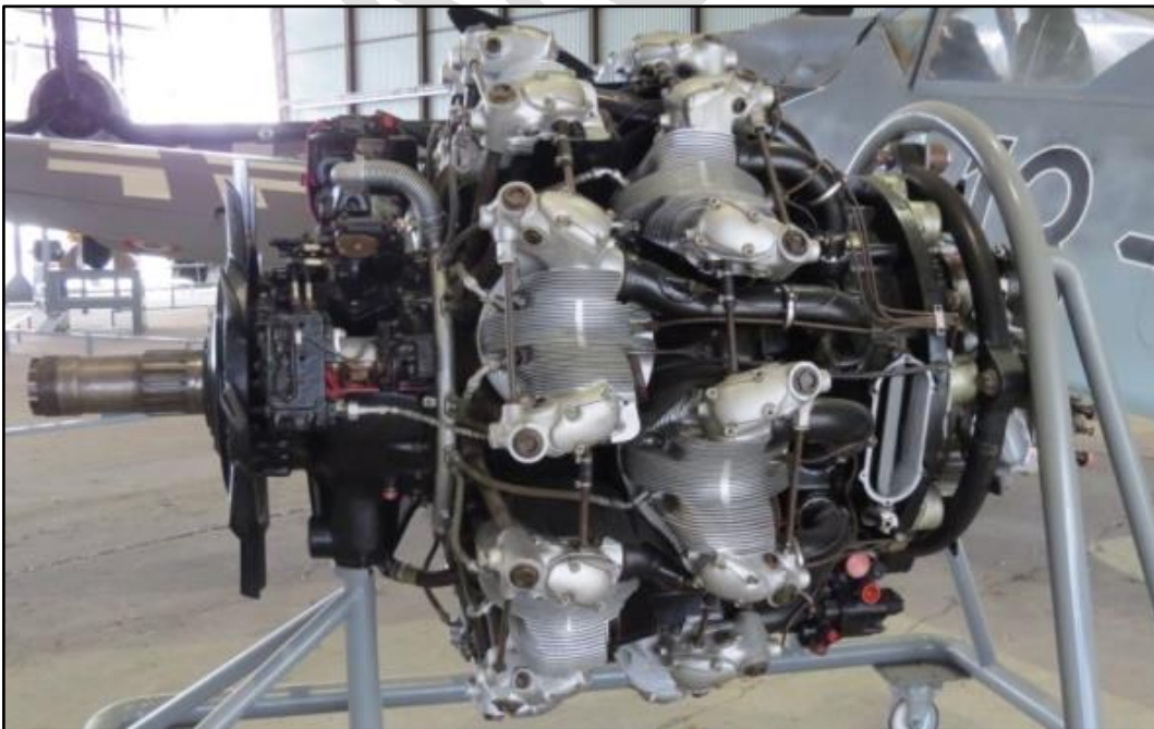
Figuur 24. Eenzelfde BMW 801-motor in het Musée de l'Air et de l'Espace te Le Bourget (Parijs). De veertien cilinders staan in twee rijen in stervorm gemonteerd. (foto Cynrik De Decker)
