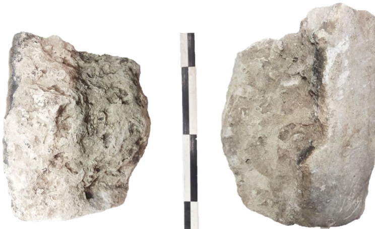
Figuur 117: Twee kasseien uit wegdek S2015, rechts een kraagsteen (© agentschap Onroerend Erfgoed, foto: Carola Stern).
