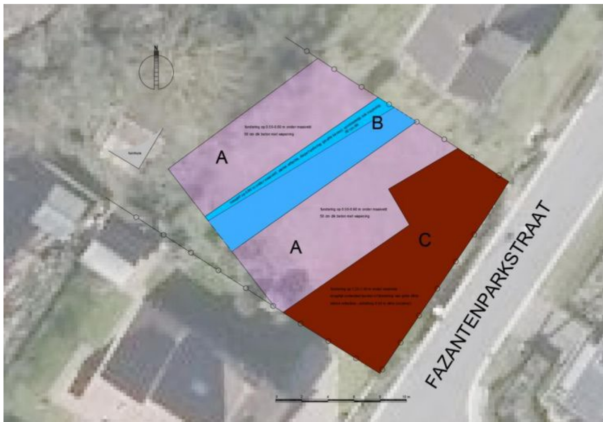
Figuur 6: Classificering van gedetecteerde funderingsrestanten op basis van de grondradarscan. © Note 2022.
