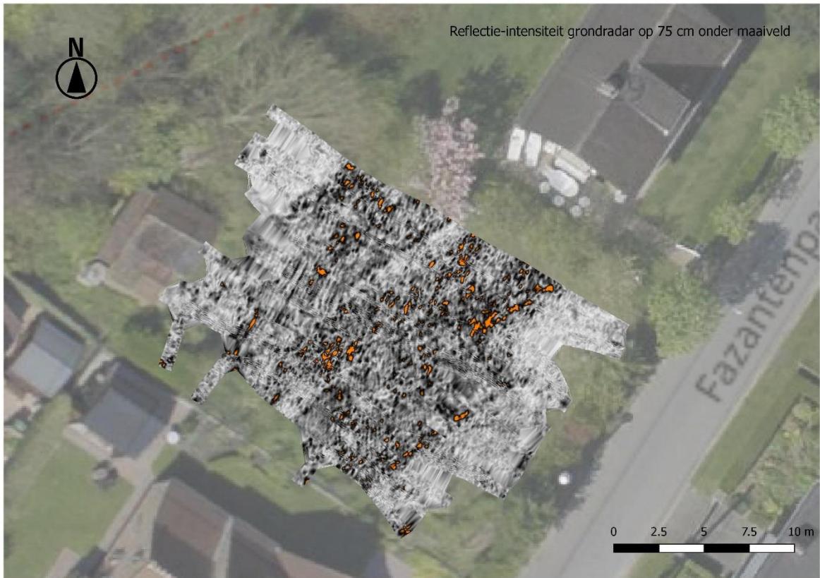
Figuur 11: Radarreflecties (intensiteit) op een diepte van 0.75 m onder het maaiveld.
