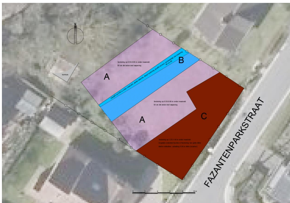
Figuur 10: Classificering van gedetecteerde funderingsrestanten op basis van de grondradarscan.
