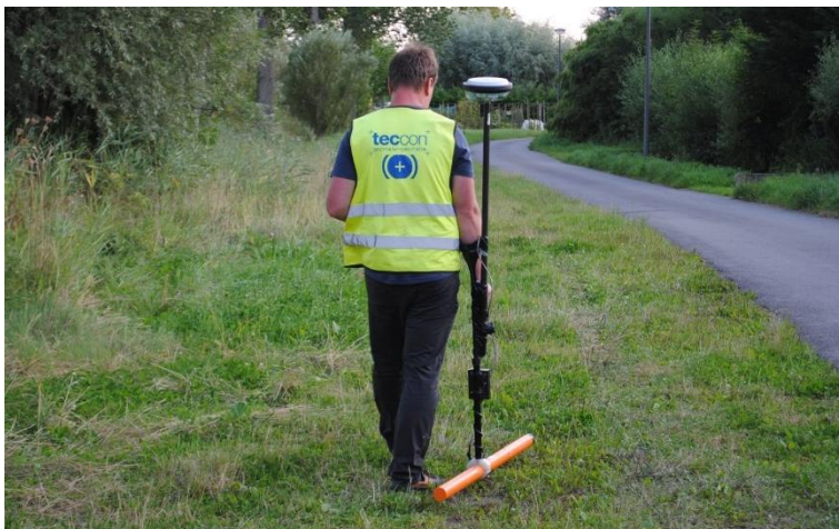
Figuur 3: Scan-setup van het EMI toestel met GNSS-antenne.
