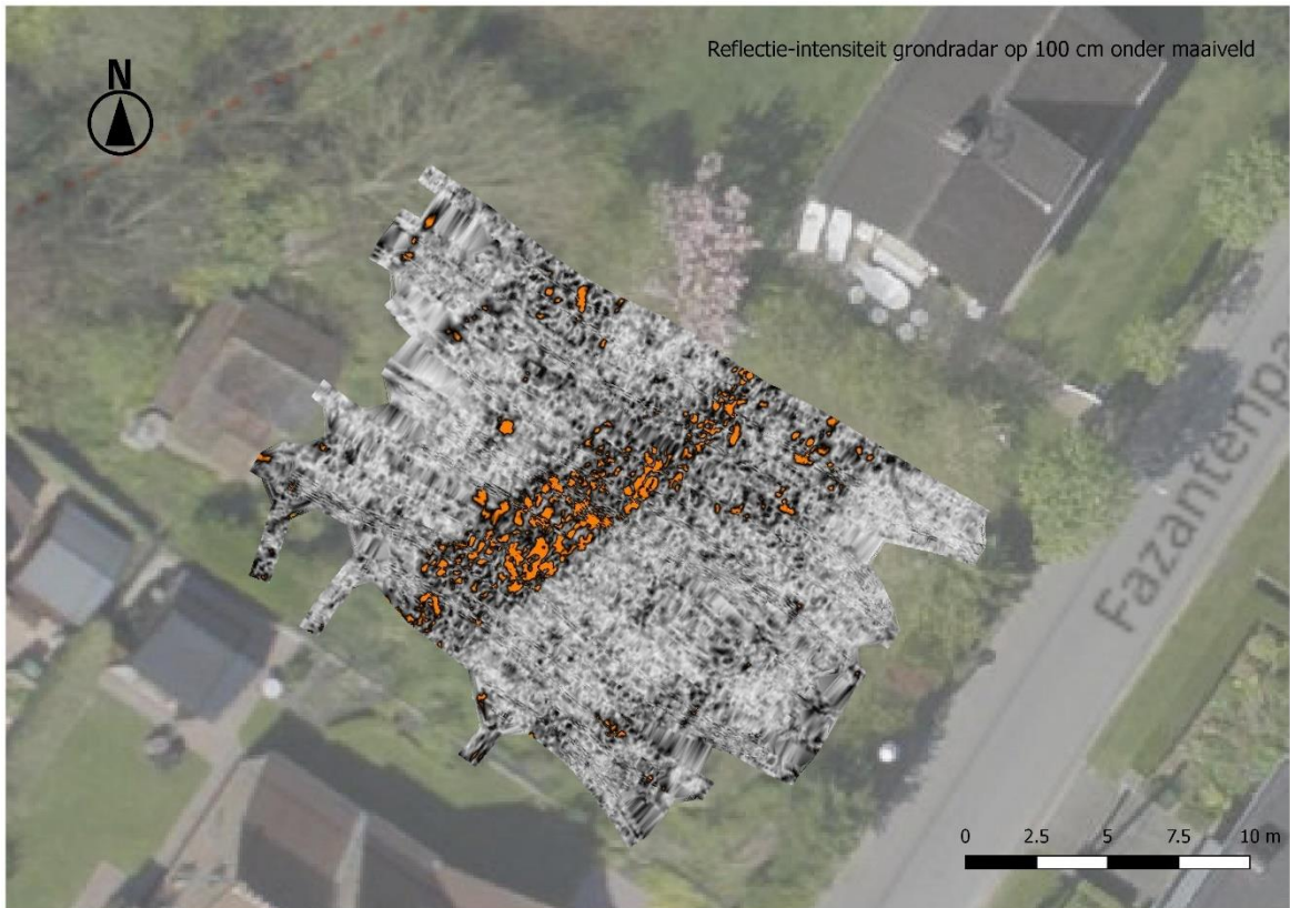
Figuur 12: Radarreflecties (intensiteit) op een diepte van 1.00 m onder het maaiveld.
