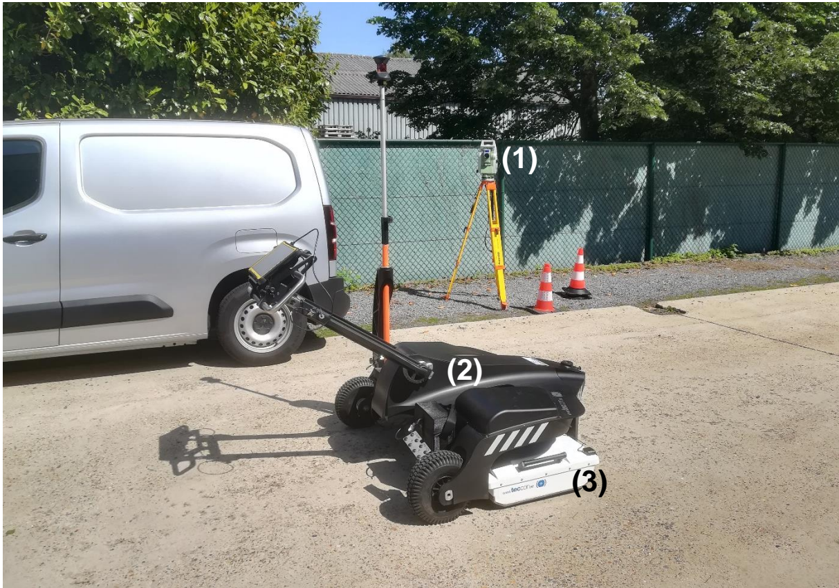
Figuur 2: Scan-setup van de grondradar: prisma en totaalstation (1), gemotoriseerde kar (2) en radarantenne (3).
