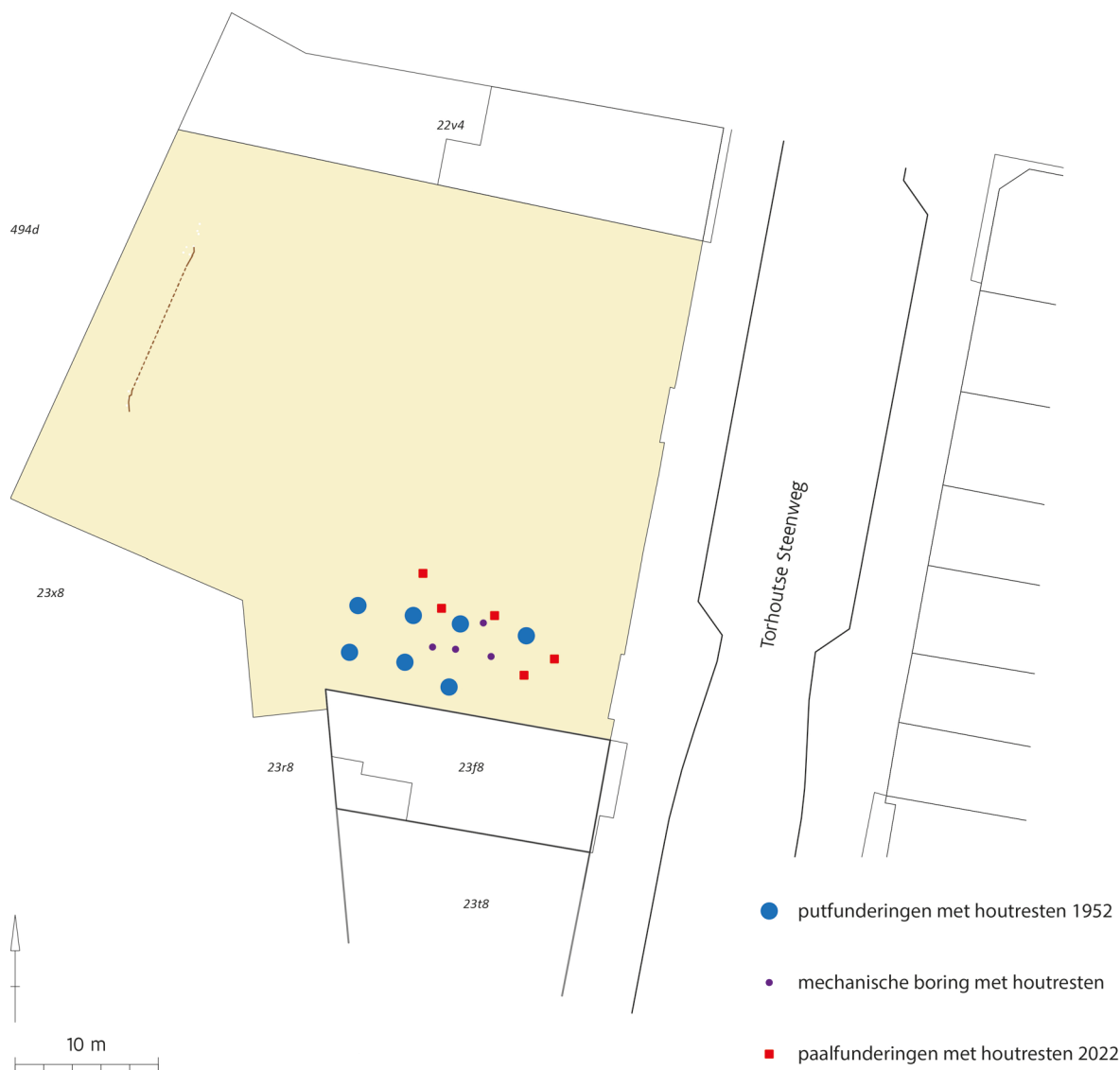
Figuur 5: Plan met kadastrale perceelnummers, perceelsgrenzen, afbakening van het onderzochte gebied (ingekleurd). Op het plan zijn aangeduid: de putfunderingen uit 1952 (met aanwezigheid van houtresten), de mechanische boringen (met aanwezigheid van houtresten) en de paalfunderingen (met aanwezigheid van houtsnippers rond het boorgat), © agent-schap Onroerend Erfgoed, plan: Johan Van Laecke, afwerking illustratie Sylvia Mazereel.
