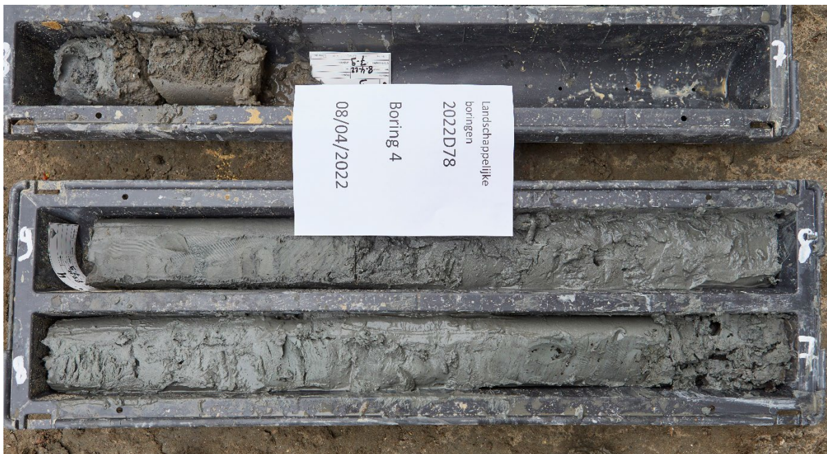
Figuur 33: Mechanische boring 4, de witte cijfers op de plasticen bak geven de richting aan: 7-8, 8-9, © agentschap Onroerend Erfgoed, foto: K. Vandevorst, 08/04/2022.
