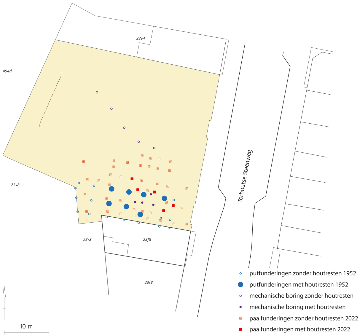
Figuur 4: Plan met kadastrale perceelnummers, perceelsgrenzen, afbakening van het onderzochte gebied (ingekleurd). Op het plan zijn aangeduid: de putfunderingen uit 1952 (met en zonder aanwezigheid van houtresten), de mechanische boringen (met en zonder aanwezigheid van houtresten) en een deel van de paalfunderingen (met en zonder aanwezigheid van houtsnippers rond het boorgat), © agentschap Onroerend Erfgoed, plan: Johan Van Laecke, afwerking illustratie Sylvia Mazereel.
