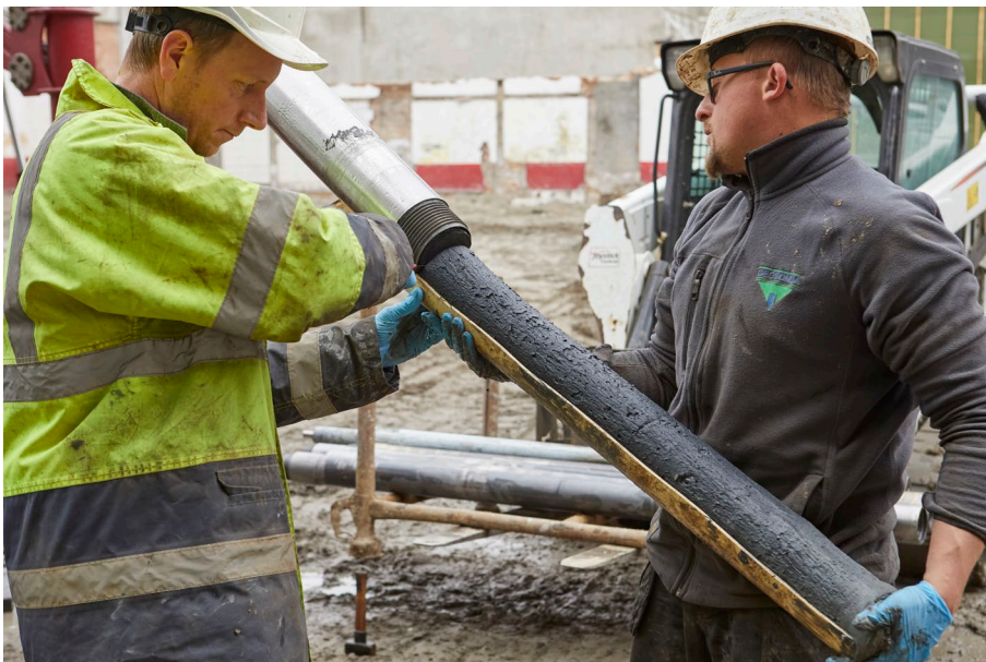
Figuur 2: De Aqualock 100 mm levert ongestoorde bodemstalen die naderhand voor verder onderzoek beschikbaar zijn, © agentschap Onroerend Erfgoed, foto: Kris Vandevorst, 08/04/2022.
