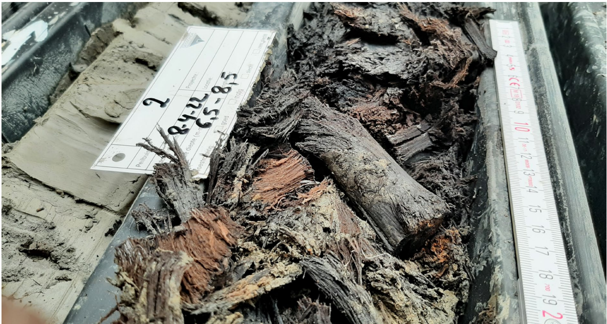
Figuur 13: Houtresten waaronder een tap met bijbehorend tapgat aangetroffen in het ongestoorde bodemstaal van boring 2 tussen 6,5 en 8.5 diepte ten opzichte van het voetpad ter hoogte van het perceel, © agentschap Onroerend Erfgoed, foto: Kristof Haneca, 04/05/2022.
