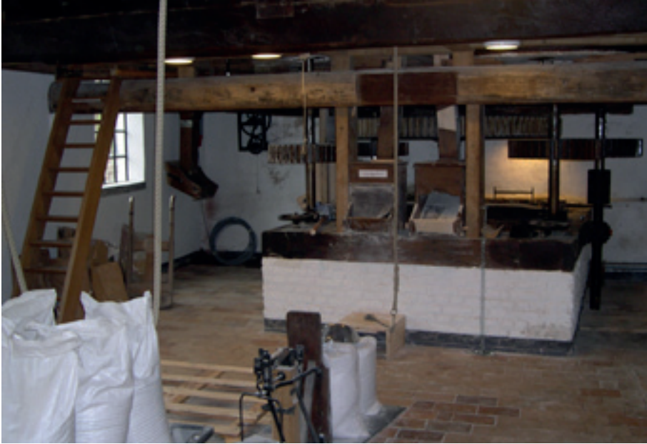
▲ Brede opgemetselde asput of "hel" met spoorwiel en sterrenwielen.
