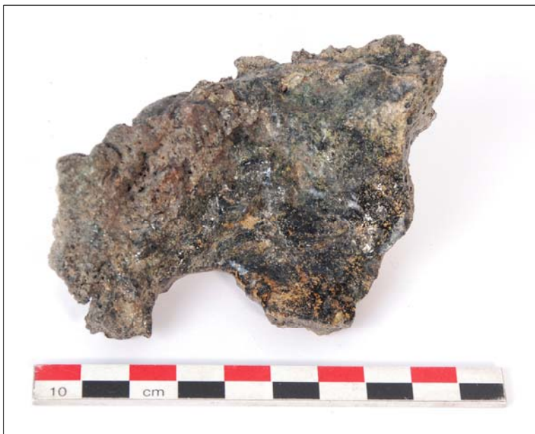
Fig. 29. Een smidseslak met gat veroorzaakt door luchttoevoer (foto G. Van Rompaey).
