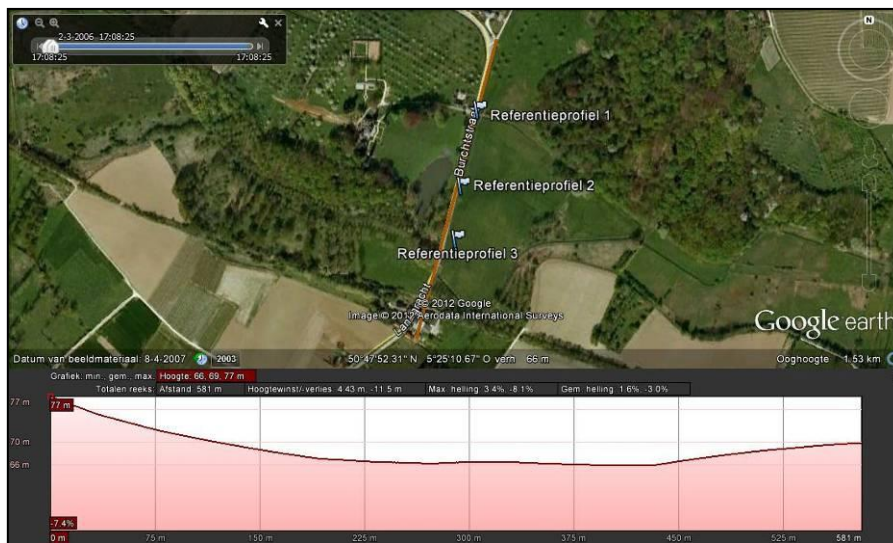
Fig. 4: Noord - zuid lengteprofiel van het oppervlak en de helling in het projectgebied.
