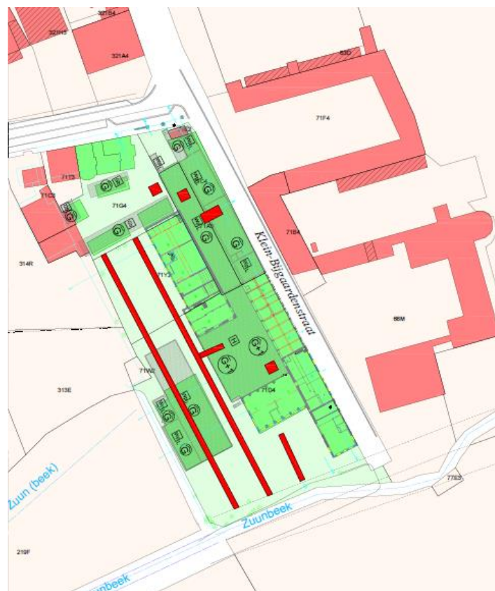
Fig. 20 Voorstel tot werkputinplanting op basis van de bureaustudie. De gearceerde zones zullen gesloopt worden.
