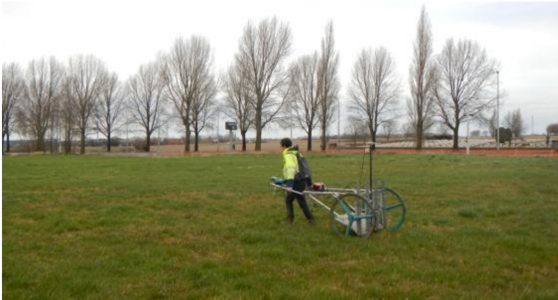
Figuur 6. Magnetometrische oppervlakedetectie in uitvoering op de site met op de achtergrond het New Irish Farm Cemetery .
