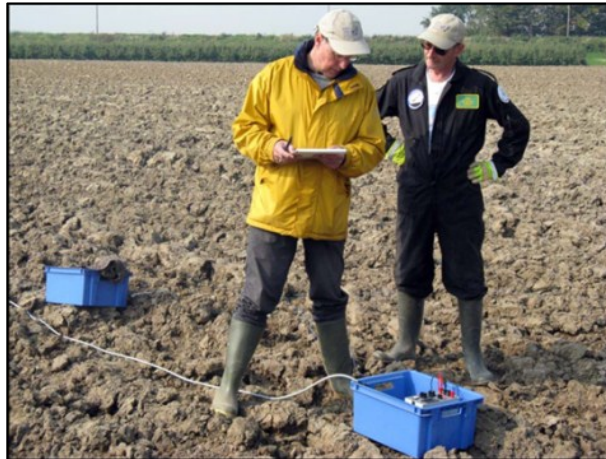
Figuur 14. Luc Hendrickx op stap met z'n zelfbouw differentiële proton precessie magnetometer
