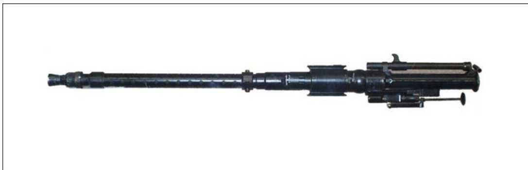
Figuur 11. De Rheinmetall Borsig MG 17 vuurde patronen af van 7.92mm - de Bf110 had er vier aan boord.
