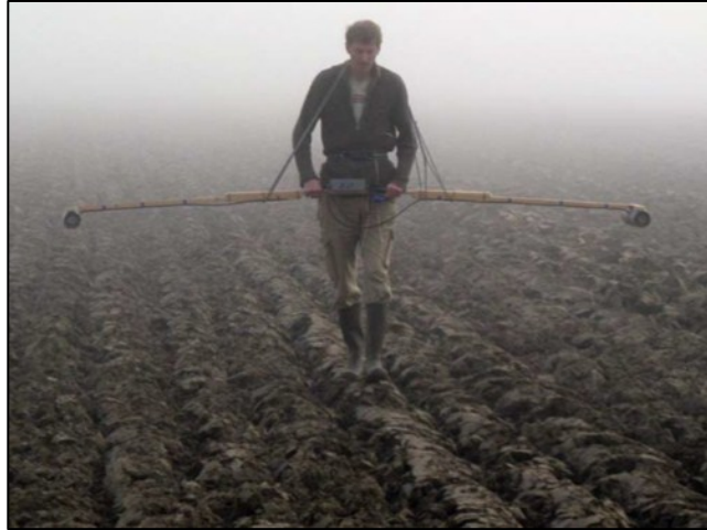
Figuur 14. Luc Hendrickx op stap met z'n zelfbouw differentiële proton precessie magnetometer
