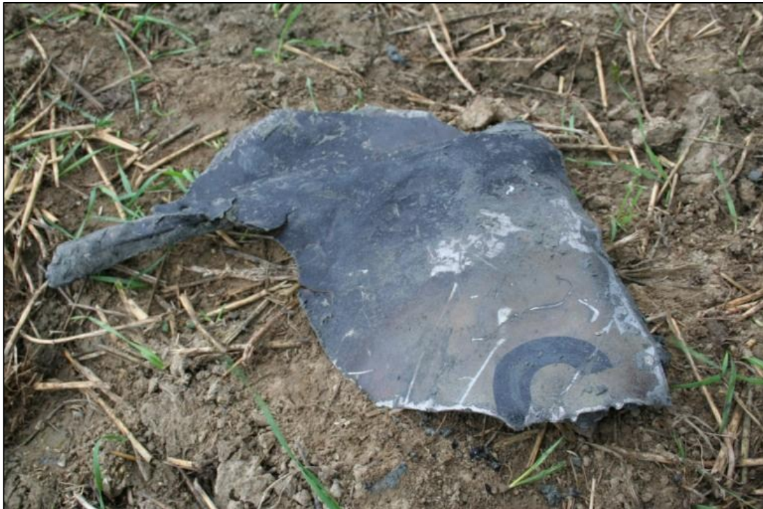
Figuur 38. Stuk carrosserie, aluminium bekleed
