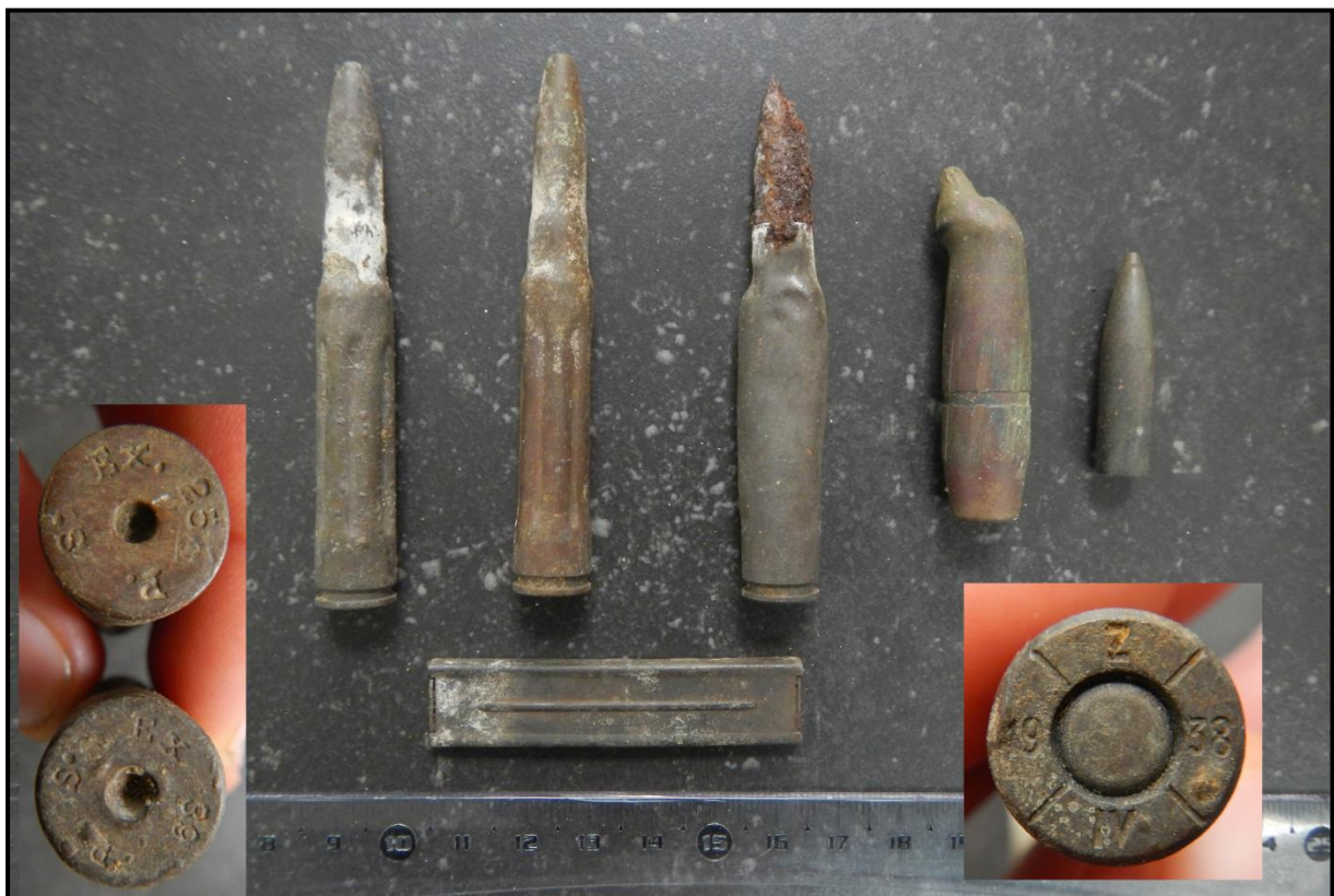
Figuur 55: Zicht op de aangetroffen munitie met enkele details van de backstampcode's.
