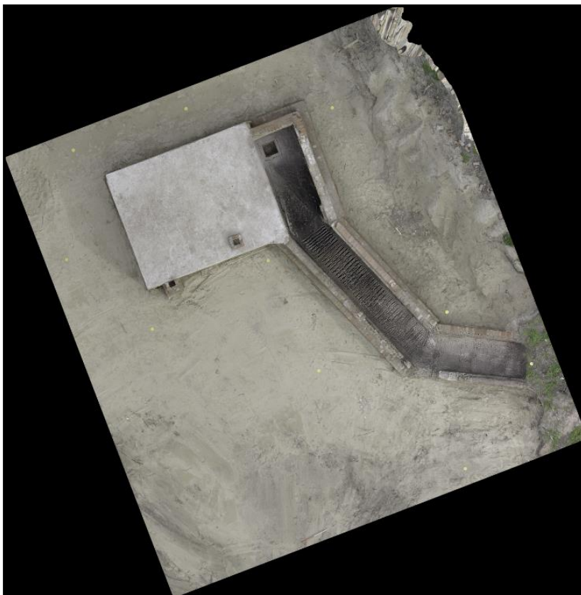
Figuur 39: Bovenaanzicht structuur 1 met de toegangloopgraaf komende van de Overwinningsslaan en de bakstenen bunker met betonnen dakconstructie en ventilatieschachten (© Jeroen De Reu, GATE bvba).
