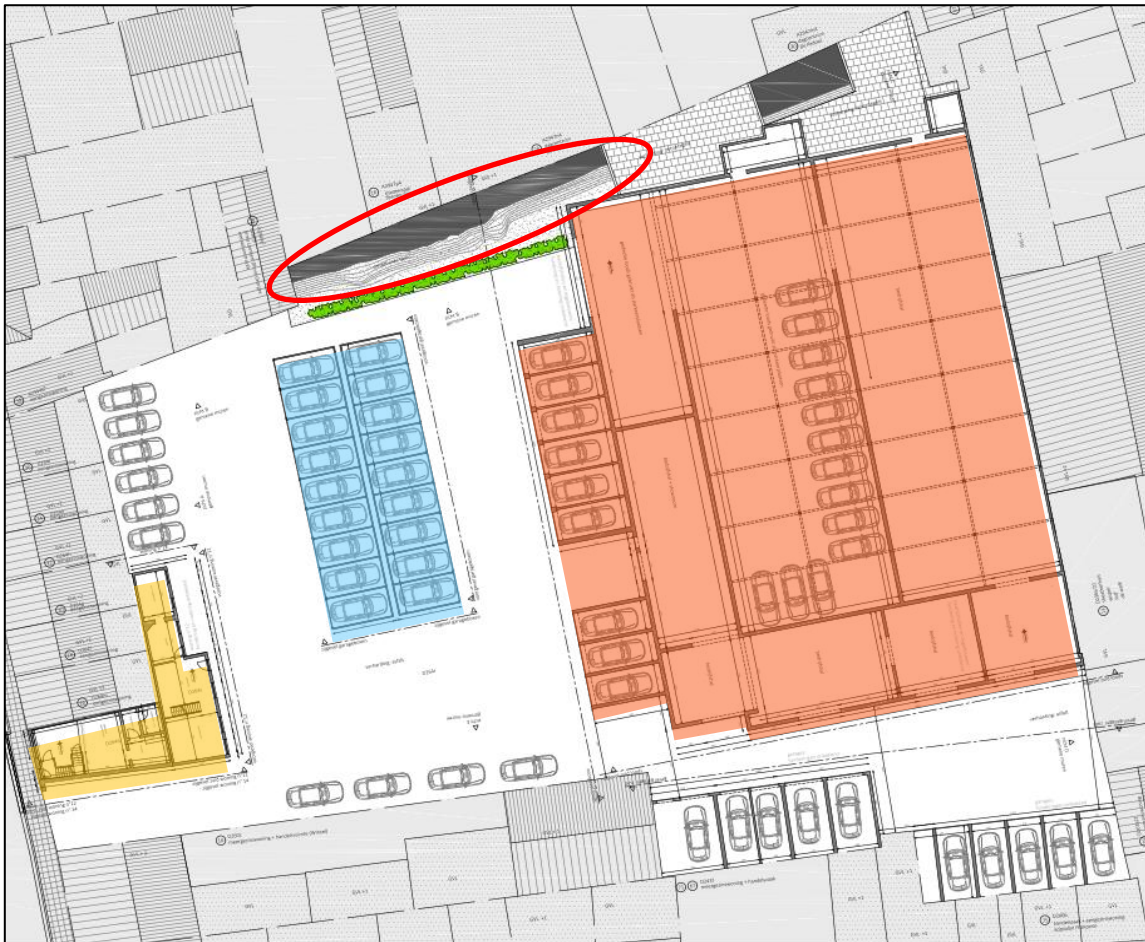
Figuur 5: Bestaande situatie (voor de sloop) binnen de onderzoekslocatie. geel: te slopen pand aan de straatkant en huis met lage koer; blauw: moderne garageboxen; oranje-rood: voormalig fabriekspand. In rood omcirkeld is het restant van het Leopold-vaardeken (zie verder).
