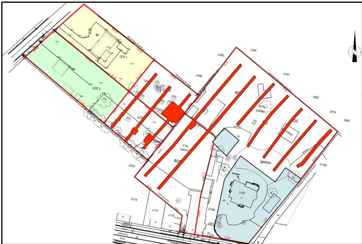
Figuur 16: Het uiteindelijke sleuvenplan. De zones in het lichtblauw geven aan waar geen sleuven konden getrokken worden door de aan de gang zijnde afbraakwerken.
