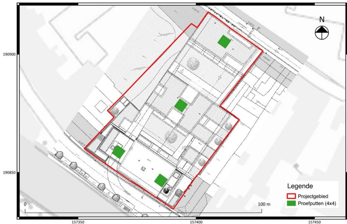
Fig. 3.42: Voorstel tot inplanting van de proefputten.
