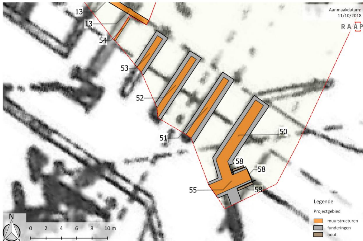
Figuur 13: Overzicht van de verschillende aangetroffen bouwkundige elementen die geïnterpreteerd werden als onderdelen van de spoorwegbrugpoort op een ontwerpplan van de Brialmontvesting. (bron: NGI, 2018)
