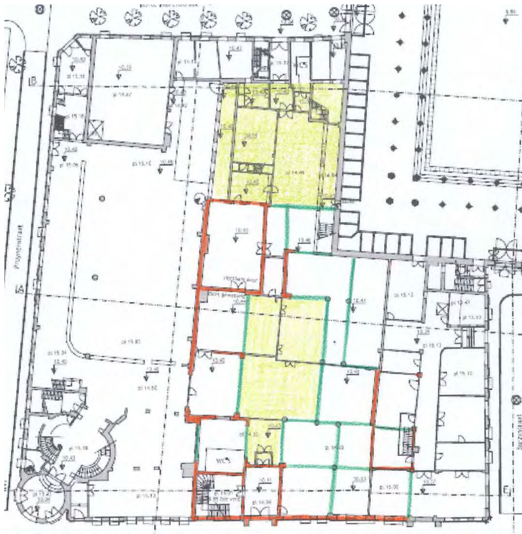
Fig. 2.10: Plan van de panden Lange Nieuwstraat 20-24 met aanduiding van de oudere muren (rood), de situering van de voormalige binnenplaats en tuin (geel) en een mogelijke aanvulling van de plattengrond van hotel Du Bois rond 1829 (groen) 43 .
