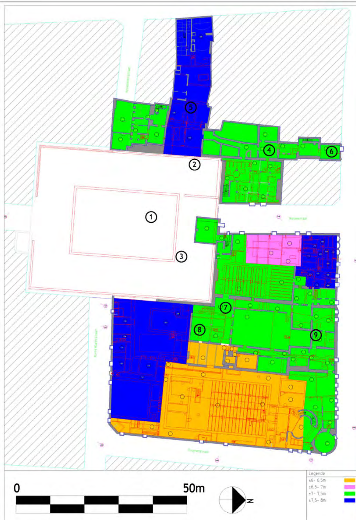
Fig. 2.14: Locatie van de aangelegde proefputten (1-3) en de overige sonderingen (4-9).
