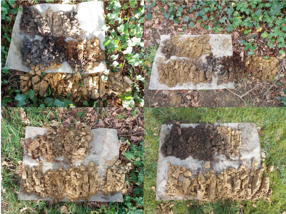
Fig. 2.3. Dessel-Vogelzangstraat. Vier representatieve boorprofielen. Linksboven boring 1 met dun stuifzanddek op volledig intacte humuspodzolbodem in het zuidwestelijke deel van het plangebied. Rechtsboven boring 16 Stuifzand op volledig intacte humuspodzolbodem in het noordoostelijke deel van het plangebied. Linksonder boring 15 met stuifzanddek op C-horizont in dekzand in het noordoostelijke deel van het plangebied. Rechtsonder boring 8 met afgetopt bodemprofiel in centraal deel van het plangebied.
