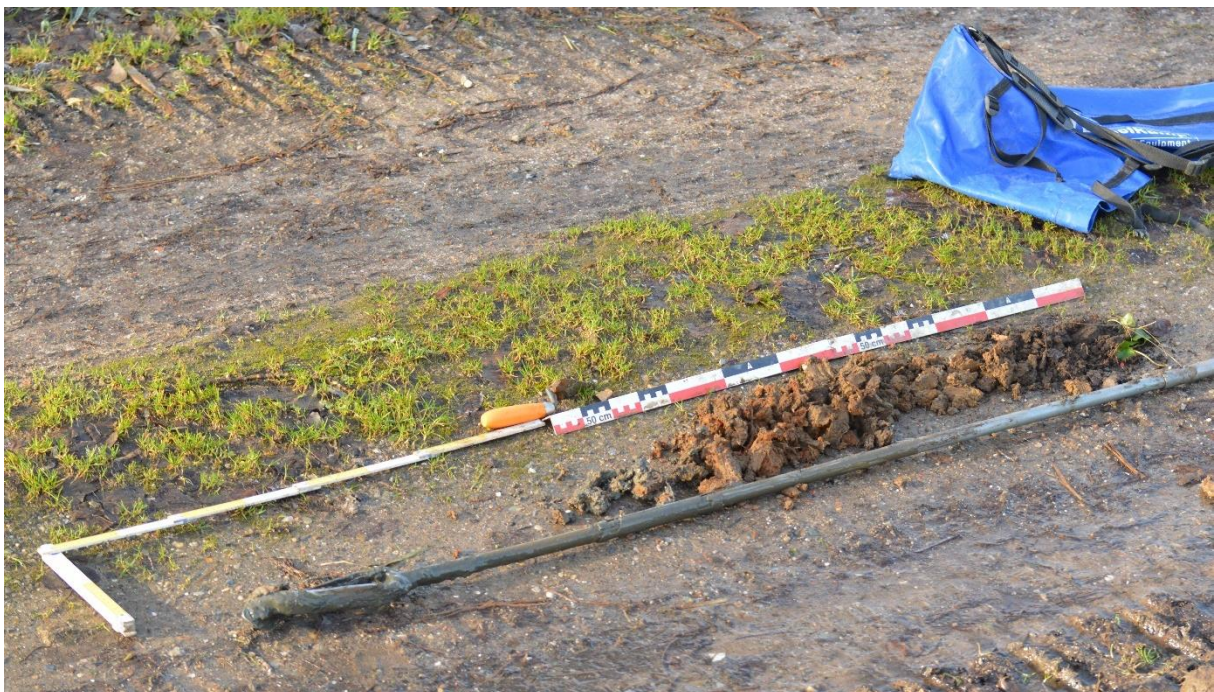
Figuur 25: Boring B4 ten zuidoosten van sleuf 1. De boorkop geeft de diepte aan, maar sediment ontbreekt door de natte omstandigheden van de ondergrond.
