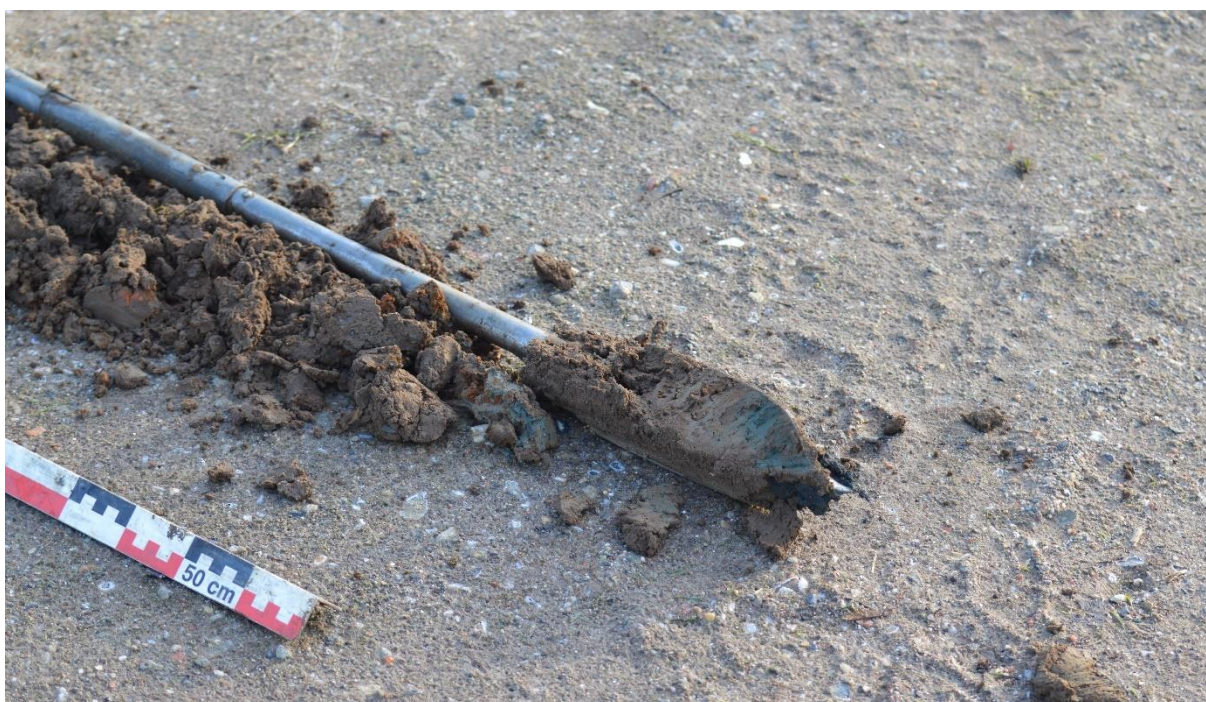
Figuur 26: Boring B5 leverde dezelfde blauwe kleilaag op als in profiel 2 ca. 1m onder het maaiveld.
