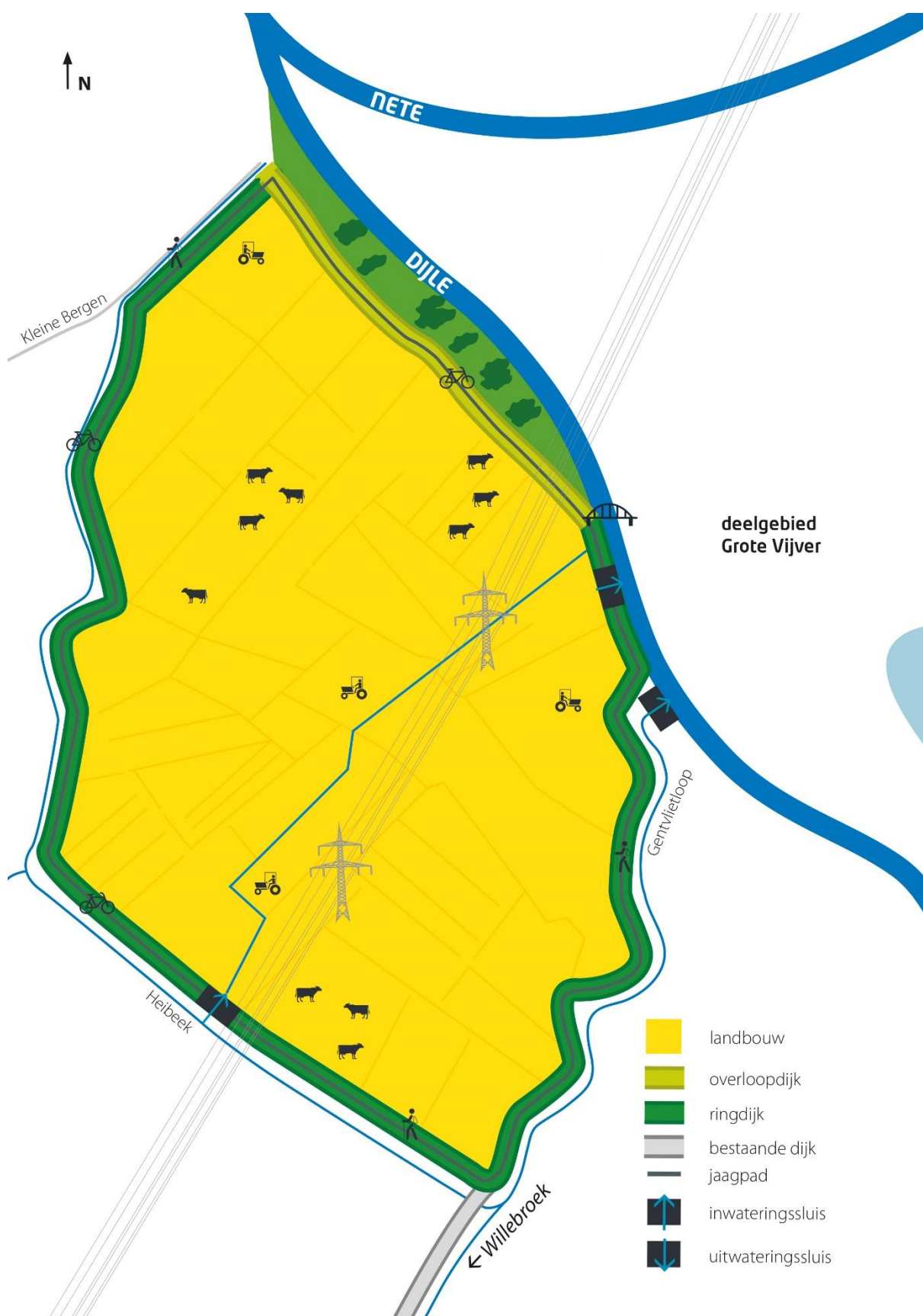
Figuur 1: Schematisch ontwerp van het overstromingsgebied (©De Vlaamse Waterweg).
