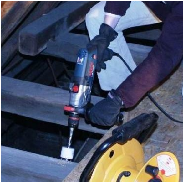
Fig. 7. Voorbeeld van bemonstering in de vorm van een boorkern met behulp van een kernboor van 16 mm diameter bevestigd op een elektrische boormachine. © KIK-IRPA, Brussel, werkfoto
