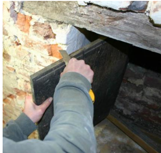
Fig. 10. Voorbeeld van voorbereiding voor een opname met macrofotografie: 'meetbaan' geprepareerd met behulp van een cuttermesje. © KIK-IRPA, Brussel, werkfoto
