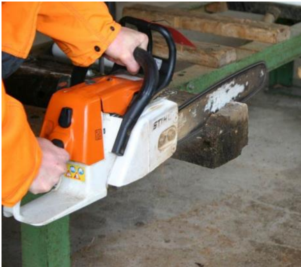
Fig. 9. Voorbeeld van verzaging ter plaatse van een stuk van het te dateren houtelement. © KIK-IRPA, Brussel, werkfoto
