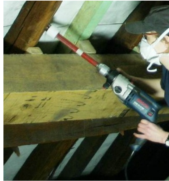
Fig. 8. Voorbeeld van bemonstering in de vorm van een boorkern met behulp van een kernboor van 23 mm diameter bevestigd op een elektrische boormachine. © KIK-IRPA, Brussel, werkfoto
