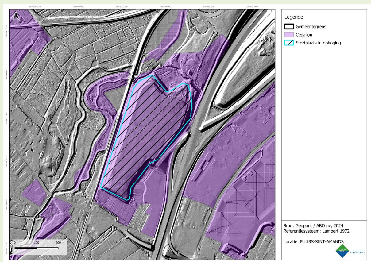
Figuur 29: Stortplaats in ophoging te Puurs-Sint-Amands die duidelijk herkenbaar is op het Digitaal hoogtemodel, informatie bevestigd o.b.v. bodemdossier 19966
