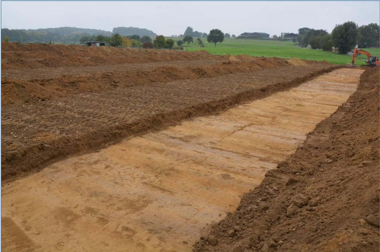
Figuur 137. Proefsleuf WP11. De bleke banden, dwars op de sleuf komen overeen met kalkrijke loess. De okerkleurige banden met colluvium in geulen of ravijnen afgezet. (Foto St. Dondeyne)
