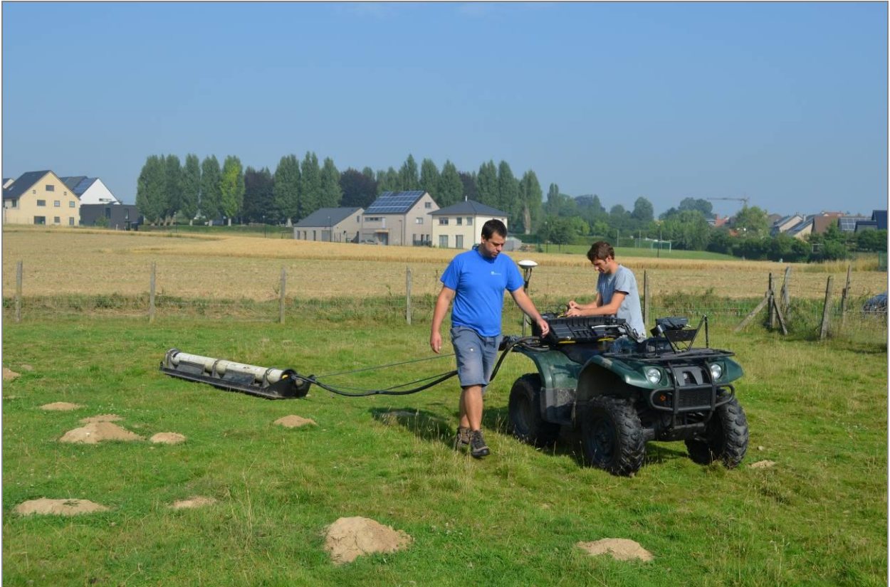
Figuur 81. Mobiele sensorconfiguratie met de EMI sensor in de slede en differentiële GPS gemonteerd op de quad, gebruikt in het onderzoeksgebied. (Foto: Walter Sevenants 23/08/2013)
