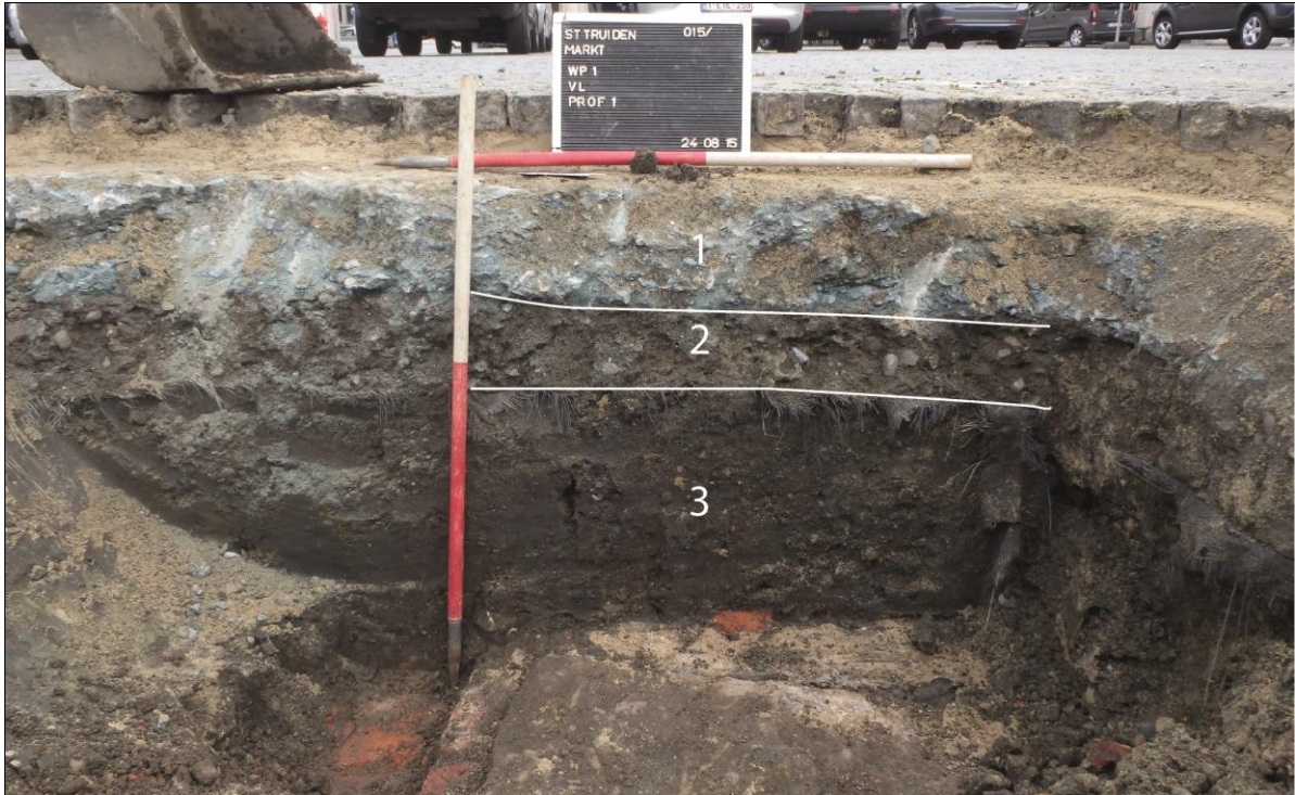
Figuur 27: foto van het profiel van het proefputje. 1) eerste, betonnen stabilisatielaag, 2) tweede, kiezelrijke stabilisatielaag en 3) oudere, puinrijk ophoogpakket. In het vlak is de bakstenen riolering met natuurstenen afdekplaat nog zichtbaar (BAAC, 2015).
