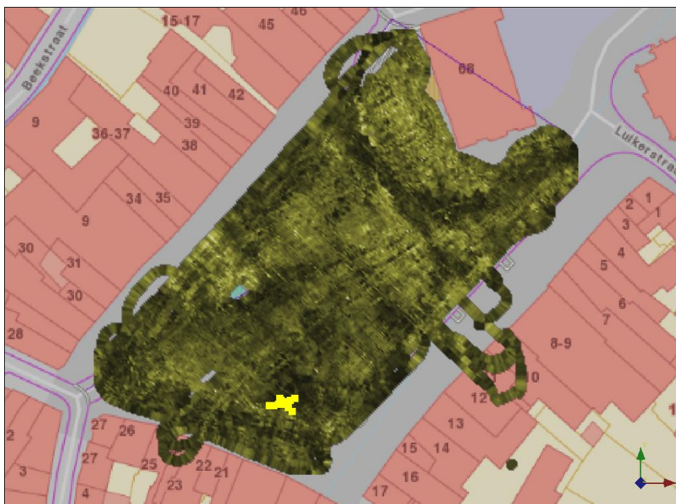
Figuur 118: locatie depressie, greppel (0,5 – 1,2m onder maaiveld)
