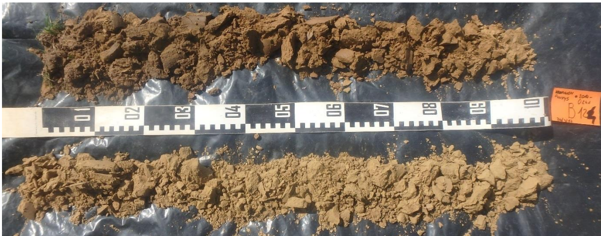
Figuur 89: Boring 124 van 0 (linksboven) tot 200 cm (rechtsboven) beneden het maaiveld (©BAAC).
