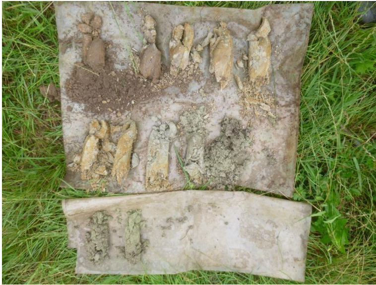
Fig. 3.5. Geetbets – Sanering Hulsbeek (22.531). Boring 22 met een dunne, humeuze bovenlaag op zware leem met roestvlekken.
