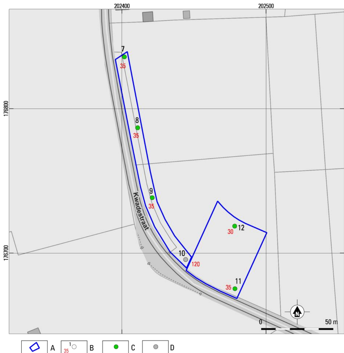
Fig. 3.2. Geetbets – Sanering Hulsbeek (22.531). Boorpuntenkaart buffergracht 4 en terrein voor grondverbetering. A. grens onderzoeksgebied. B. boring met nummer (zwart) en dikte geroerde bovenlaag in cm (rood); C. boring met textuur-B-horizont D. boring met diep verstoord bodemprofiel.
