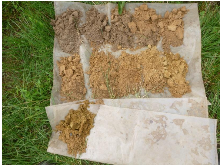
Fig. 3.4. Geetbets – Sanering Hulsbeek (22.531). Boring 13 met textuur-B-horizont direct onder de bouwvoor.
