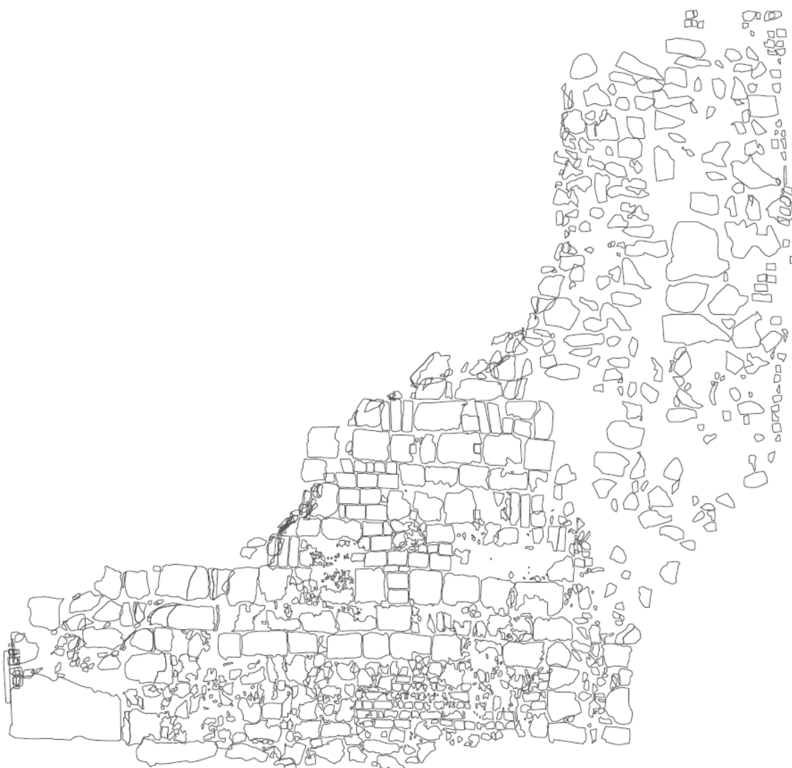
Fig. 3.1: Fotogrammetrische opmeting van de binnenmuur van de toren.
