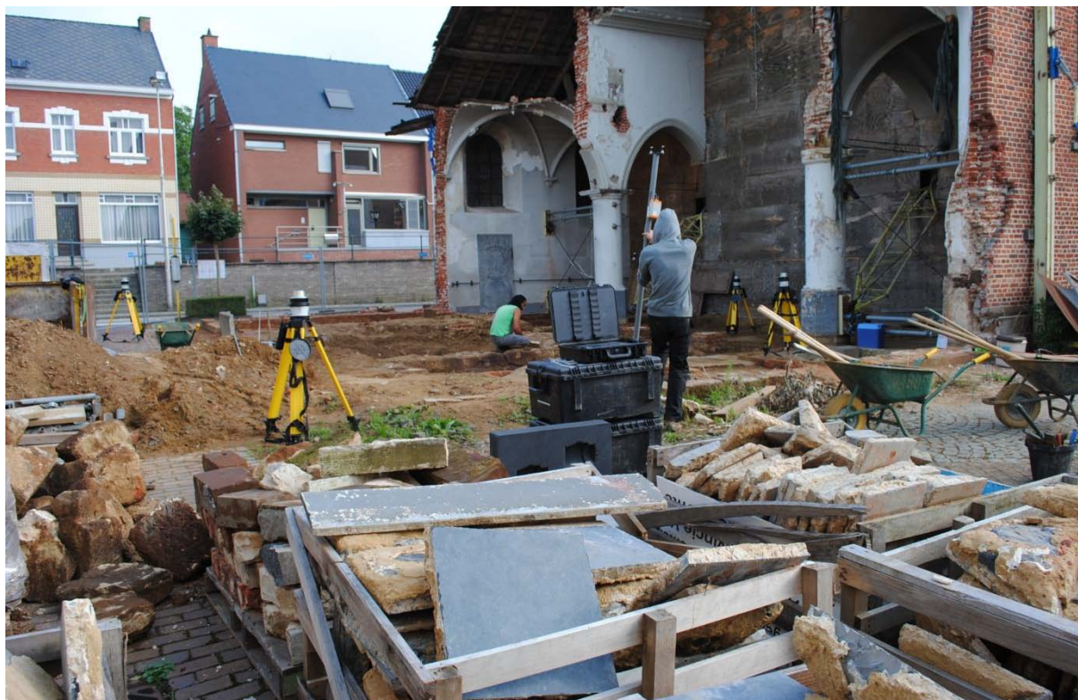
Fig. 3.10: Het digitaal intekenen met de iSpace for Archaeology van het eerste aangelegde vlak.
