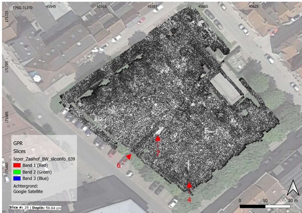
Figuur 9: Horizontale dieptedoorsnede van de GPR data op 60 cm diepte met de amplitude enveloppe in grijswaardenschaal (zwart: zwak reflectief tot wit: sterk reflectief) met aanduiding van de belangrijkste anomalieën.
