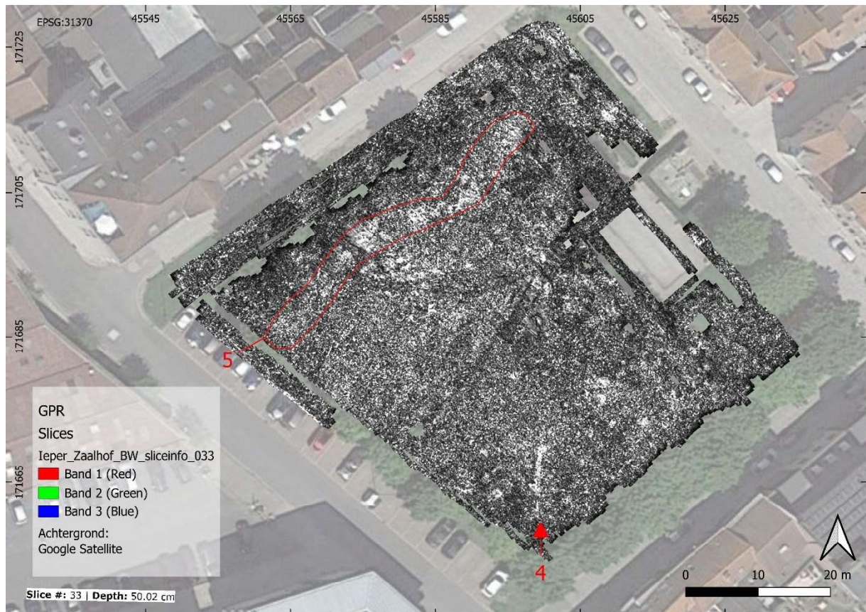
Figuur 8: Horizontale dieptedoorsnede van de GPR data op 50 cm diepte met de amplitude enveloppe in grijswaardenschaal (zwart: zwak reflectief tot wit: sterk reflectief) met aanduiding van de belangrijkste anomalieën.
