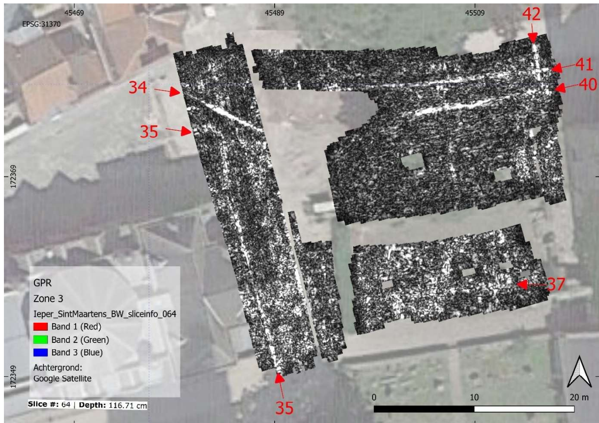
Figuur 20: Horizontale dieptedoorsnede van de GPR data op 117 cm diepte met de amplitude enveloppe in grijswaardenschaal (zwart: zwak reflectief tot wit: sterk reflectief) met aanduiding van de belangrijkste anomalieën.
