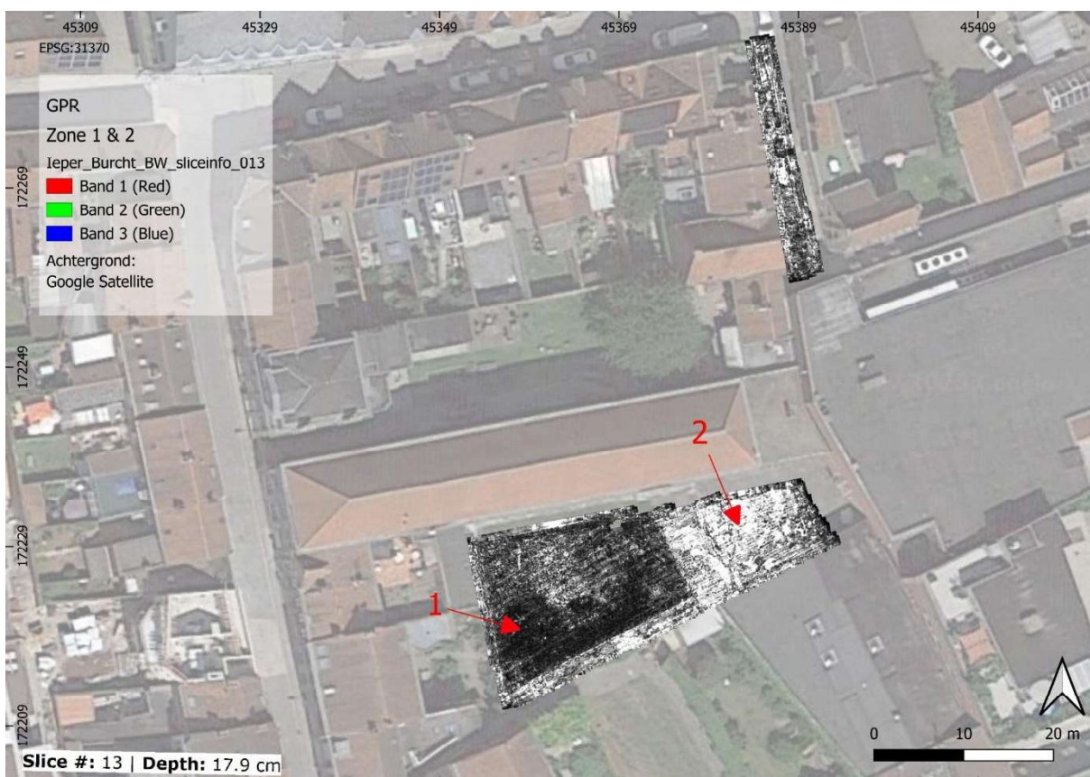
Figuur 9: Horizontale dieptedoorsnede van de GPR data op 18 cm diepte met de amplitude enveloppe in grijswaardenschaal (zwart: zwak reflectief tot wit: sterk reflectief) met aanduiding van de belangrijkste anomalieën.
