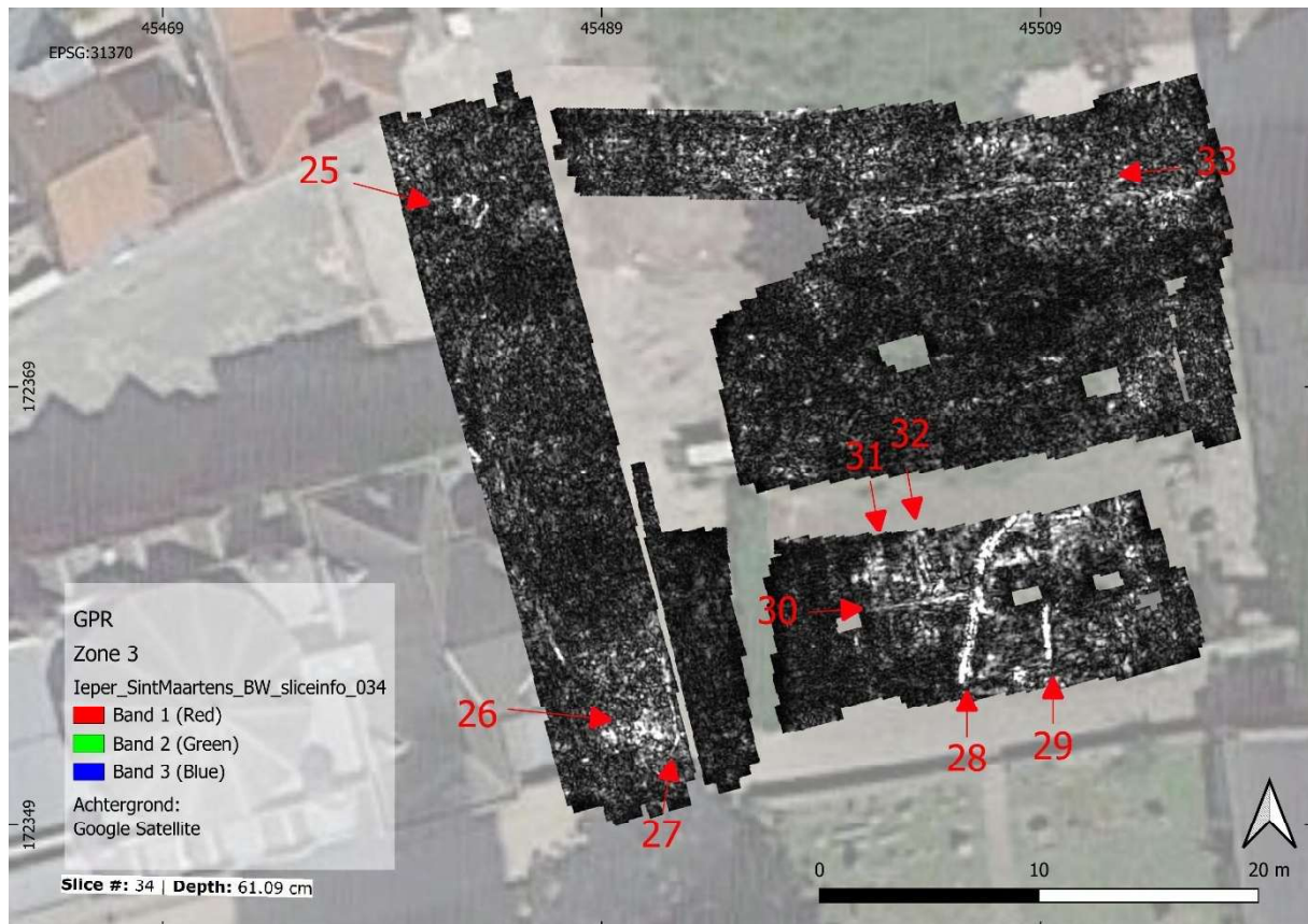
Figuur 18: Horizontale dieptedoorsnede van de GPR data op 61 cm diepte met de amplitude enveloppe in grijswaardenschaal (zwart: zwak reflectief tot wit: sterk reflectief) met aanduiding van de belangrijkste anomalieën.
