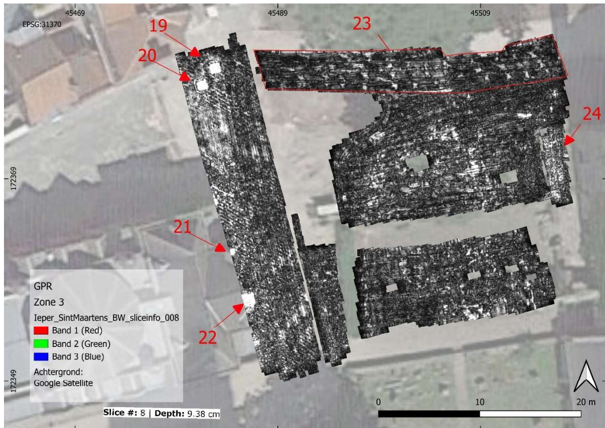
Figuur 17: Horizontale dieptedoorsnede van de GPR data op 9 cm diepte met de amplitude enveloppe in grijswaardenschaal (zwart: zwak reflectief tot wit: sterk reflectief) met aanduiding van de belangrijkste anomalieën.
