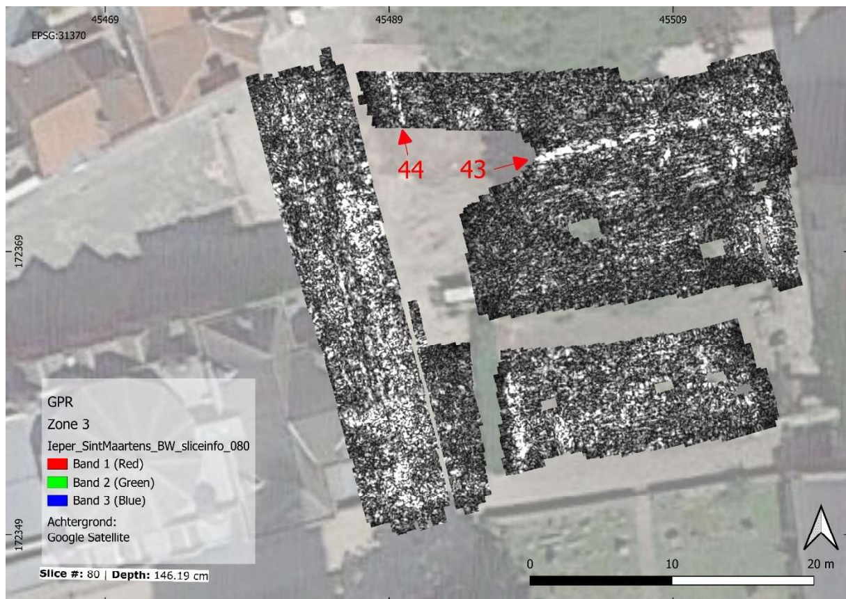
Figuur 21: Horizontale dieptedoorsnede van de GPR data op 146 cm diepte met de amplitude enveloppe in grijswaardenschaal (zwart: zwak reflectief tot wit: sterk reflectief) met aanduiding van de belangrijkste anomalieën.
