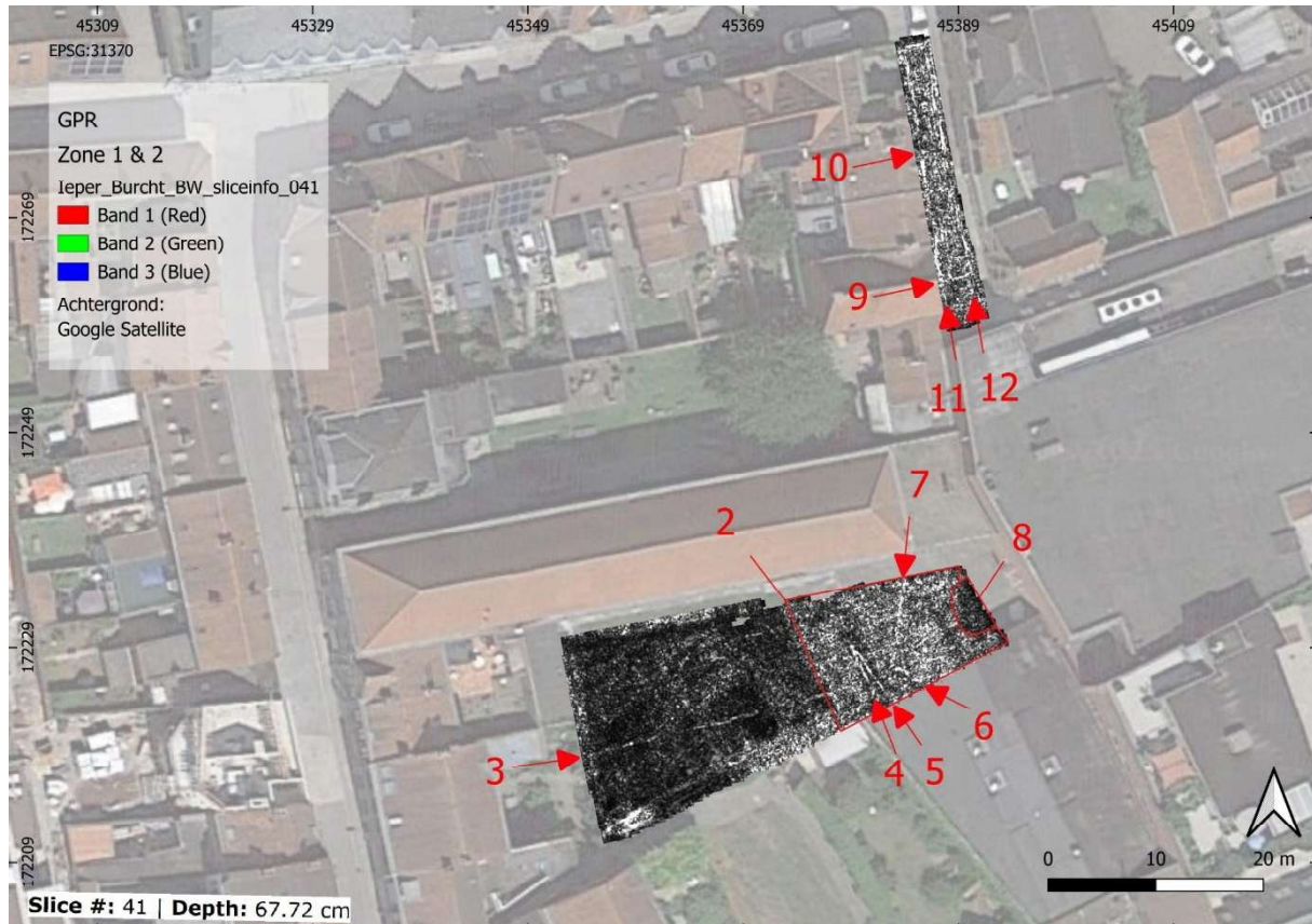
Figuur 10: Horizontale dieptedoorsnede van de GPR data op 68 cm diepte met de amplitude enveloppe in grijswaardenschaal (zwart: zwak reflectief tot wit: sterk reflectief) met aanduiding van de belangrijkste anomalieën.
