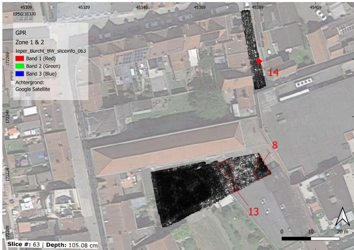
Figuur 11: Horizontale dieptedoorsnede van de GPR data op 105 cm diepte met de amplitude enveloppe in grijswaardenschaal (zwart: zwak reflectief tot wit: sterk reflectief) met aanduiding van de belangrijkste anomalieën.
