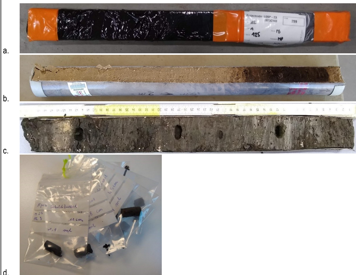
Figuur 8: Mogelijke vormen van pollenstalen: (a) verpakte pollenbak, (b) geopende boorkern (onverpakt, ter illustratie), (c) pollenbak waaruit reeds substalen genomen zijn (onverpakt, ter illustratie), (d) zakjes met substalen.
