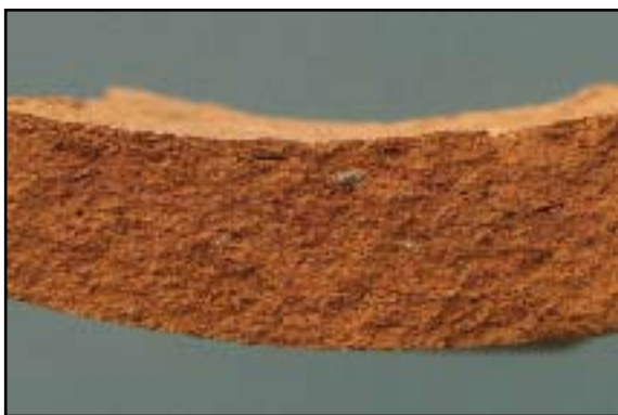
Figure 48: fresh break of a Bavay jar Figuur 48: baksel van een kruik uit de Bavay regio
